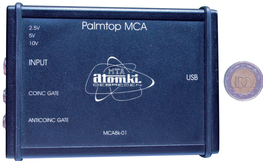
MCA8k-01 „Palmtop MCA” sokcsatornás amplitúdóanalizátor, amelynek jellemzője a kis méret, egyszerű felépítés, az USB interfész és a barátságos szoftver
