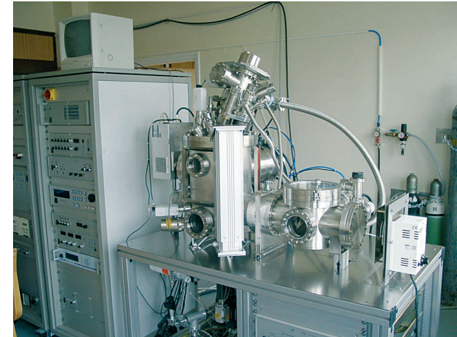
1. ábra: Az Atommagkutató Intézet és a Debreceni Egyetem Szilárdtestfizikai Tanszékének közös tulajdonát képező SPECS gyártmányú SNMS/SIMS berendezés
