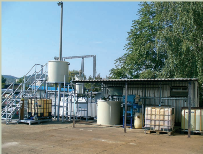
200 kg meddő/ nap kapacitású félüzemi berende- zés a rudabányai meddő kémiai feldolgozására a Multiprojekt Kft. budaörsi üzemében
