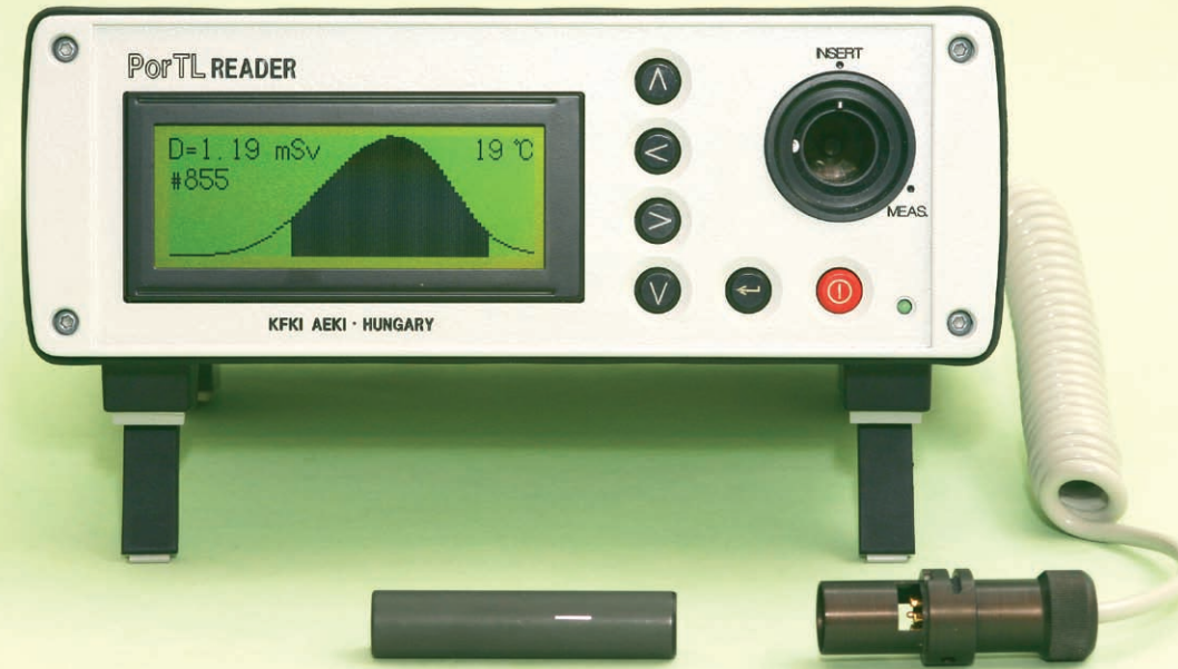
1. ábra: A PorTL kiolvási készülék, előtérben a dózismérő patron
