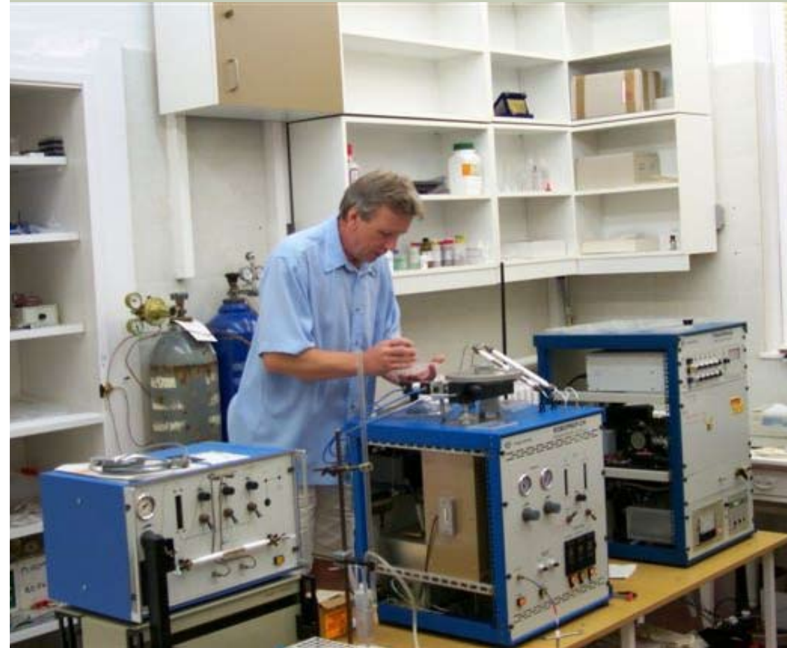
A szilárd és gázalmazállapotú minták nitrogén- és széntartalmának, valamint ^{15}\text{N}/^{14}\text{N} arányának meghatározása tömegspektrométerrel
